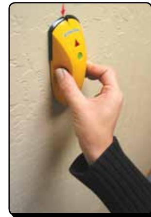
La tecnología de *Indicación de ubicación sobre vigas* le indica al usuario que la herramienta ha detectado una disminución de la densidad, por lo que se debe volver a (re)calibrar empezando desde una zona diferente de la superficie.
