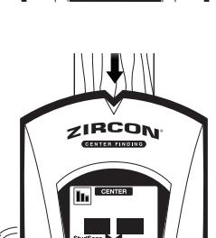
Fahren Sie entlang der Oberfläche mit dem Scannen fort. Wenn die Balkenkante ermittelt wurde, leuchten die drei Säulen auf dem Signalstärkenanzeiger, die mittleren Segmente der Zielanzeigesäulen, die MITTE-Anzeige sowie der SpotLite®-Zeiger auf, und es ertönt ein Signalton.
